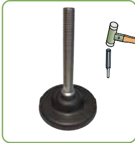
Art. R0869 - Seite R18 Ø 124 • Vorbereitet zur Bodenbefestigung • Max. Belastung 45000 N.
